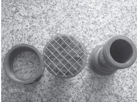
RYSUNEK 7. Cylinder z próbką: 1 – geowłóknina, 2 – siatka podtrzymująca, 3 – cylinder FIGURE 7. Cylinder with sample: 1 – non-woven geotextile, 2 – supporting mesh, 3 – cylinder
