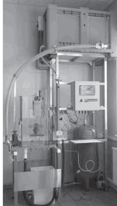
RYSUNEK 5. Widok stanowiska do wyznaczania charakterystyk wodoprzepuszczalności w kierunku prostopadłym do powierzchni wyrobu FIGURE 5. Laboratory equipment for determination of water permeability characteristics in normal direction to the plane
