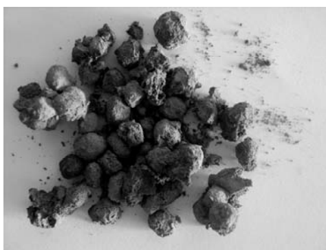
RYSUNEK 6. Posklejane cząstki złoża wydobyte z różnych filtrów FIGURE 6. Sticked particles of bed removed from different filters
