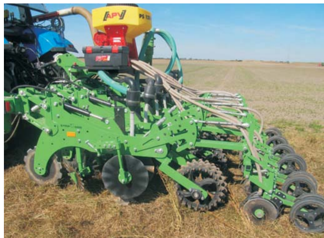
Rys. 1. Agregat do uprawy w szerokich rzędach, zbudowany w typowym układzie elementów roboczych, z naddawanym siewnikiem do rzepaku (fot. T. Piechota)
