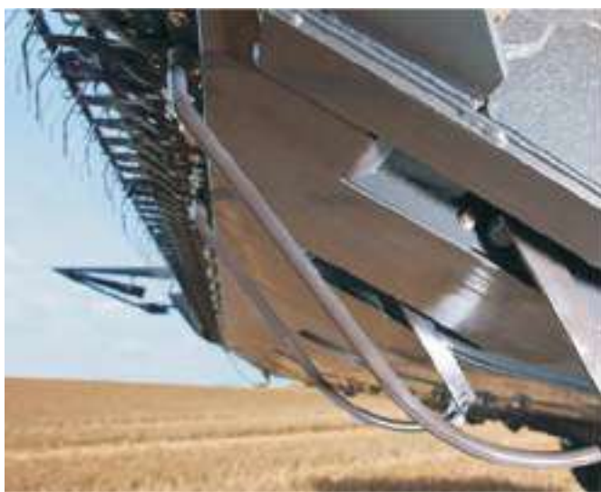
Rys. 1. Czujniki ślizgowe w przyrządzie żniwnym kombajnu zbożowego określające wysokość ścinania roślin [15]
