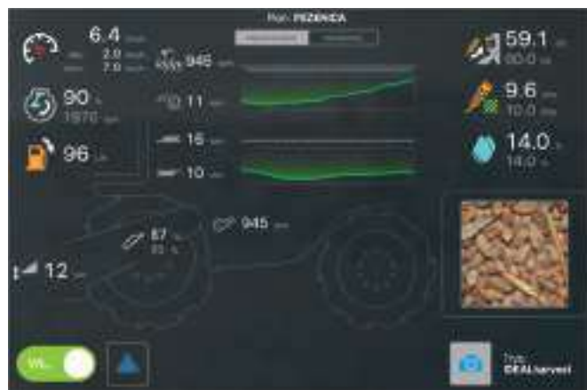
Rys. 5. Zrzut ekranu wyświetlającego system automatycznej regulacji „IDEALharvest” w kombajnie firmy FENDT - seria IDEAL
