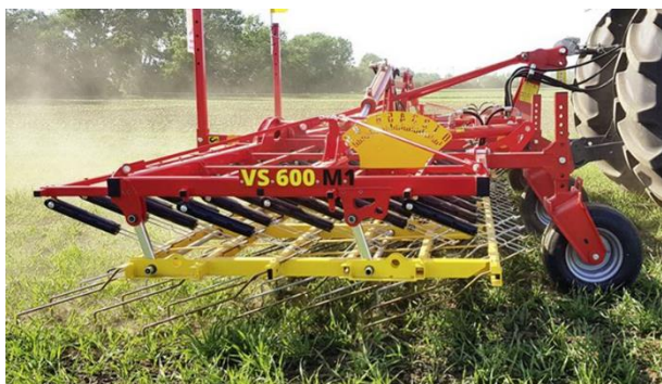
Rys. 8. Chwastownik sprężynowy VS firmy APV z zębami zabezpieczonymi osłoniętymi sprężynami [16]
