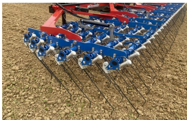
Rys. 6. Chwastownik sprężynowy Air-Flow firmy Hatzenbichler, wyposażony w zęby zabezpieczone siłownikami pneumatycznymi [14]
