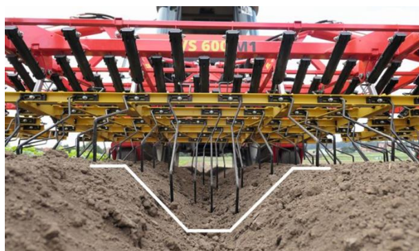
Rys. 7. Chwastownik sprężynowy VS firmy APV z zębami ustawionymi do pielęgnacji redlin [15]
