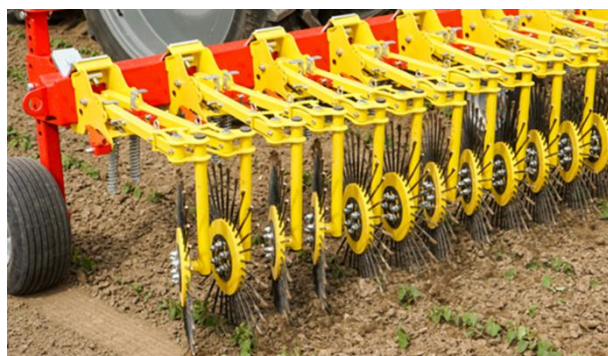
Rys. 10. Chwastownik obrotowy RH firmy APV z gwiazdami mocowanymi parami i wyposażonymi w regulację nacisku i kąta ustawienia [18]
