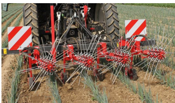
Rys. 13. Chwastownik aktywny obrotowy firmy Vanhouck Machine Engineering, wyposażony w wirniki z zębami sprężynowymi [21]
