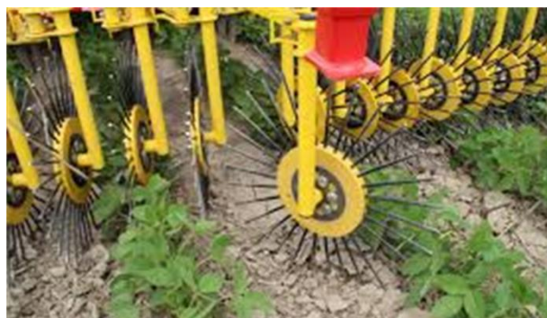
Rys. 9. Przesunięte do tyłu gwiazdy chwastownika obrotowego (APV) obrabiają środkowy pas gleby pomiędzy gwiazdami prawymi i lewymi [17]
