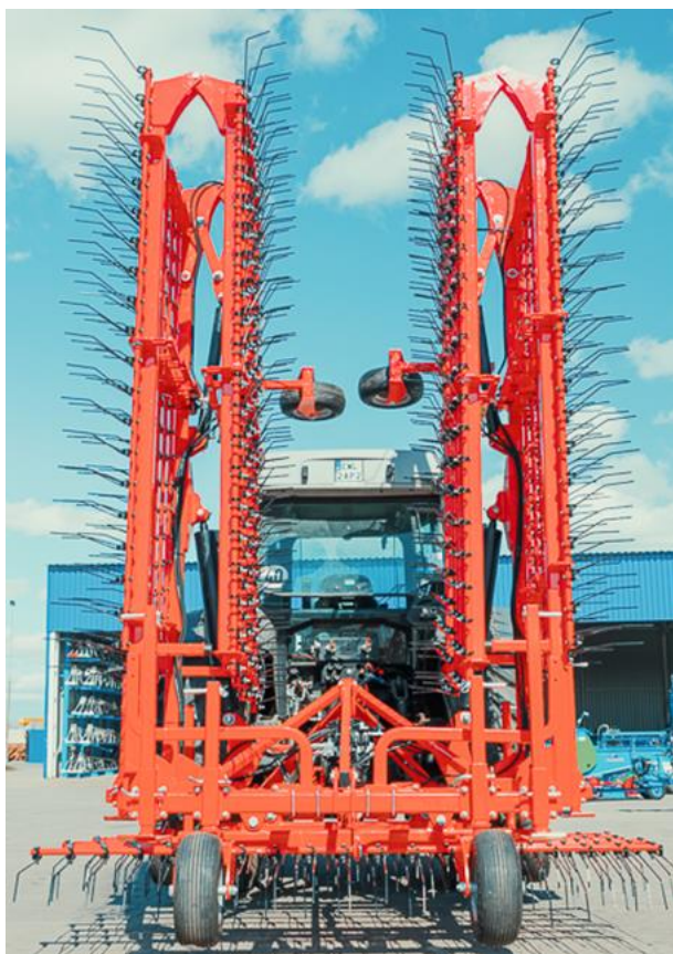
Rys. 4. Chwastownik sprężynowy firmy Krukowiak z bocznymi segmentami ramy w położeniu transportowym [12]
