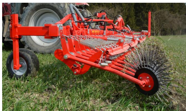
Rys. 11. Chwastownik obrotowy Aerostar Rotation firmy Einböck z gwiazdami montowanymi w sekcjach z hydrauliczną regulacją nacisku [19]
