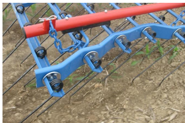
Rys. 3. Zęby sprężynowe mocowane na ceownikach (Hatzzenbichler) [11]
