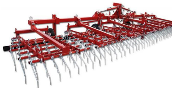
Rys. 1. Chwastownik sprężynowy firmy Klimza z wahliwie mocowanymi sekcjami [9]
