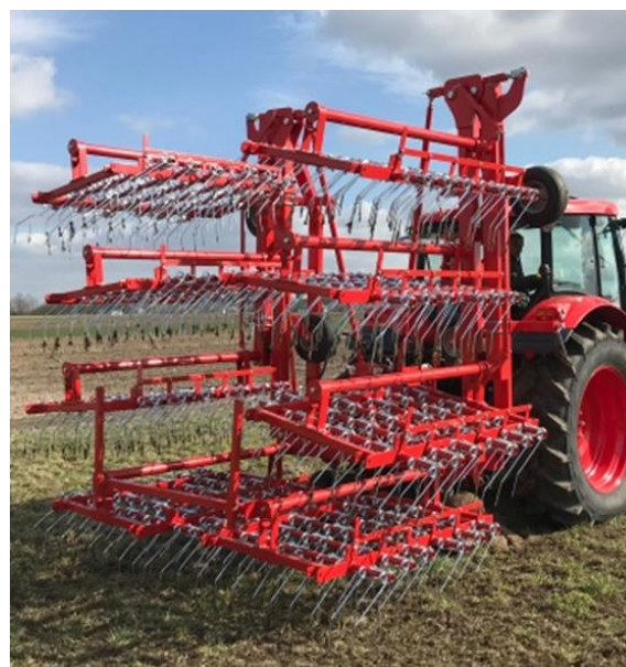
Rys. 2. Chwastownik sprężynowy firmy Jar-Met z sekcjami wypoziomowanymi w położeniu transportowym [10]
