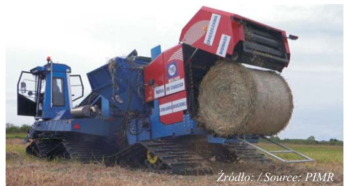
Rys. 9. Pojazd gaśienicowy do zbioru pokosu biomasy i formowania w bele przystosowany do pracy na obszarach wodno-błotnych
