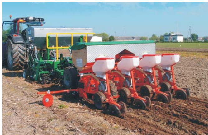
Rys. 1. Wielozadaniowy agregat do pasowej uprawy gleby i niskonakładowego oraz bezpiecznego dla środowiska systemu nawożenia i siewu nasion na uprawach szerokokorzeniowych Fig. 1. A multipurpose unit for belt planting of soil and low cost and environmentally safe system of fertilization and seeds sowing for wide row crops
