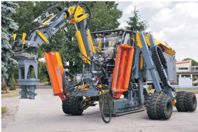
Rys. 8. Urządzenie wielozadaniowe do regeneracyjnego kształtowania otwartych cieków wodnych wg wynalazków PIMR
