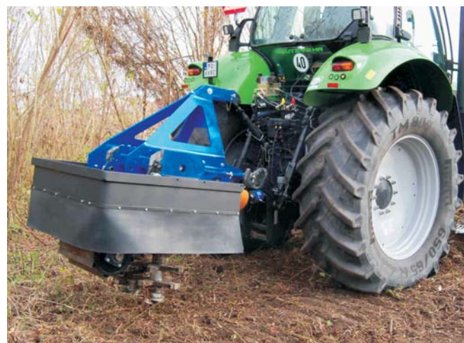
Rys. 2. Maszyna zagregowana z ciągnikiem rolniczym do rekultywacji pól po uprawie wierzby energetycznej i krzewach owocowych
