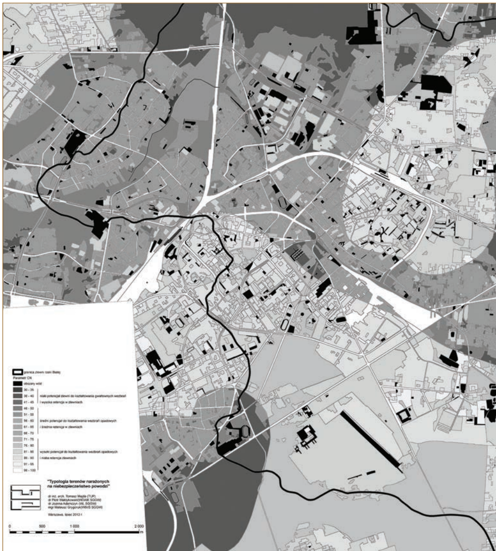
Ryc. 5. Parametr CN - potencjał do generowania wzebrań i poziom retencji w zlewni Fig. 5. The CN parameter - potential to generate floods and retention in the catchment
