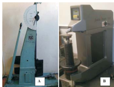
Rys. 7. Widok młota Charpy'ego do badań odporności na uderzenie materiałów (A) oraz twardościomierza Zwick ZHR/Ak (B)
