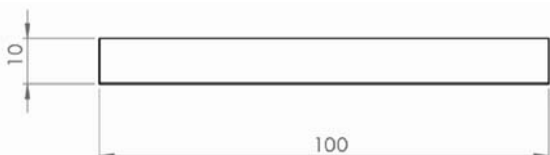
Rys. 3. Kształt i wymiary próbki do badań udarnościowych o grubości 4 mm
