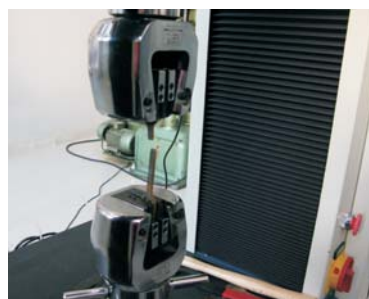
Rys. 6. Próba statycznego rozciągania próbek stalowych
