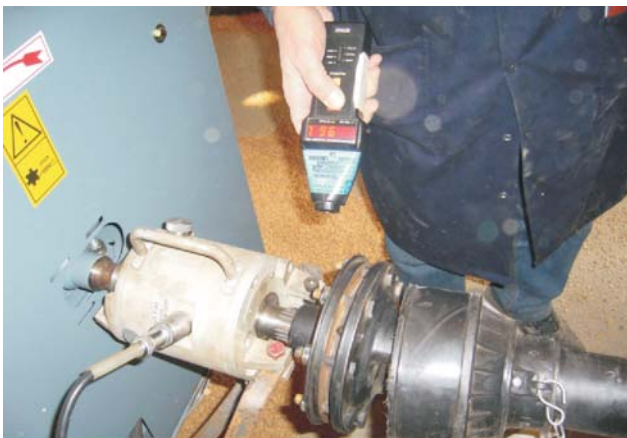
Rys. 4. Przetwornik momentu obrotowego MIR-200 oraz tachometr mikroprocesorowy CT6 Fig. 4. Torque converter MIR-200 and microprocessor tachometer CT6
