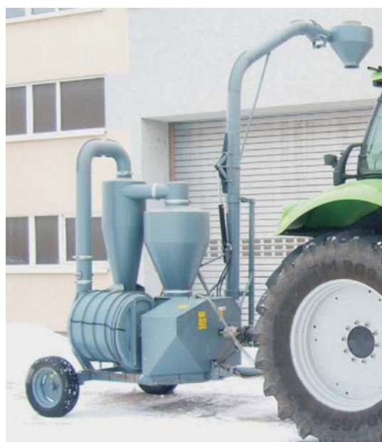
Rys. 1. Badany przenośnik pneumatyczny ssąco-tłoczący z dmuchawą pięciostopniową
