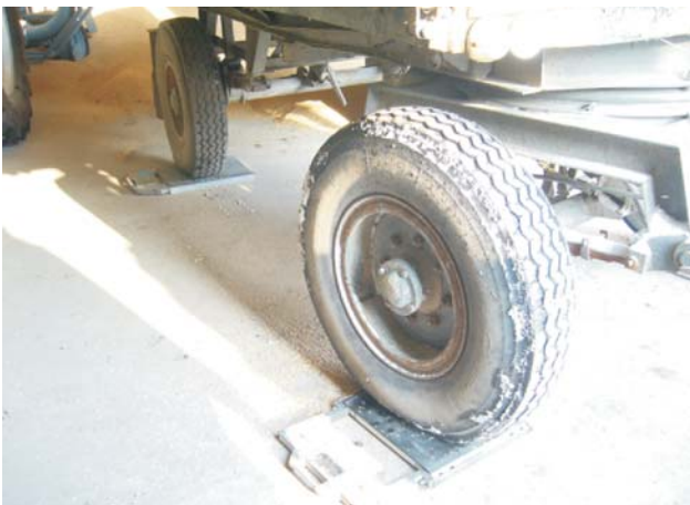
Rys. 3. Pomiar masy przetransportowanego zboża Fig. 3. Measurement of the mass of transported grain
