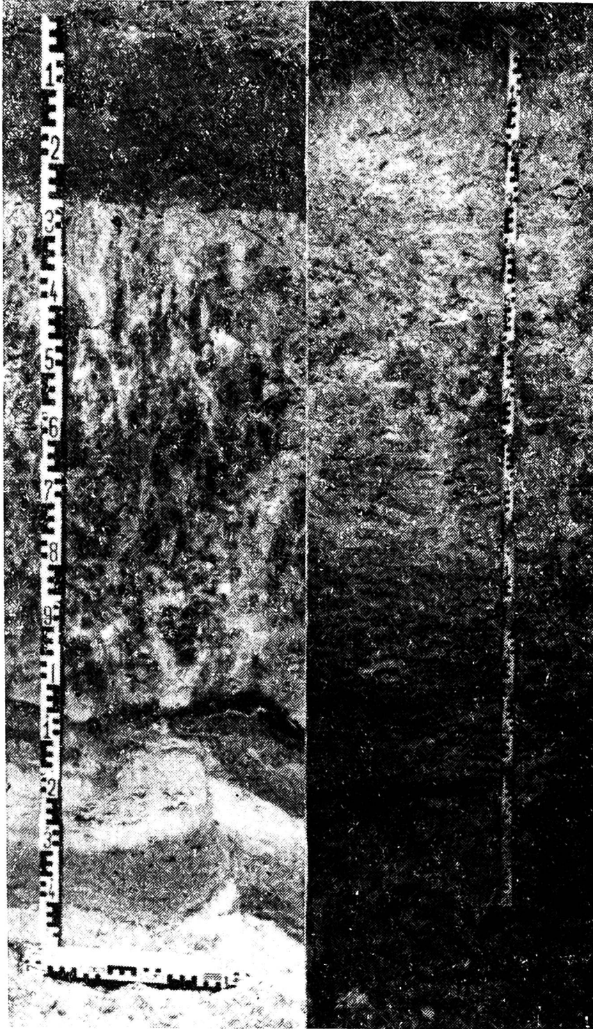
Abb. 1. Profilaufbau zweier Staugley-Standorte; links Sandstaugley-Standort A, rechts Lehmstaugley-Standort B.
