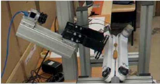
Ryc. 7. Wizyjny system detekcji orientacji żołędzi.
