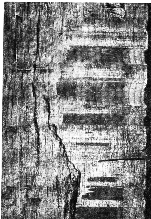
Ryc. 2. Kurczenie się promieni rdzeniowych u drewna bukowego, zaobserwowane na przekroju podłużnym promieniowym
