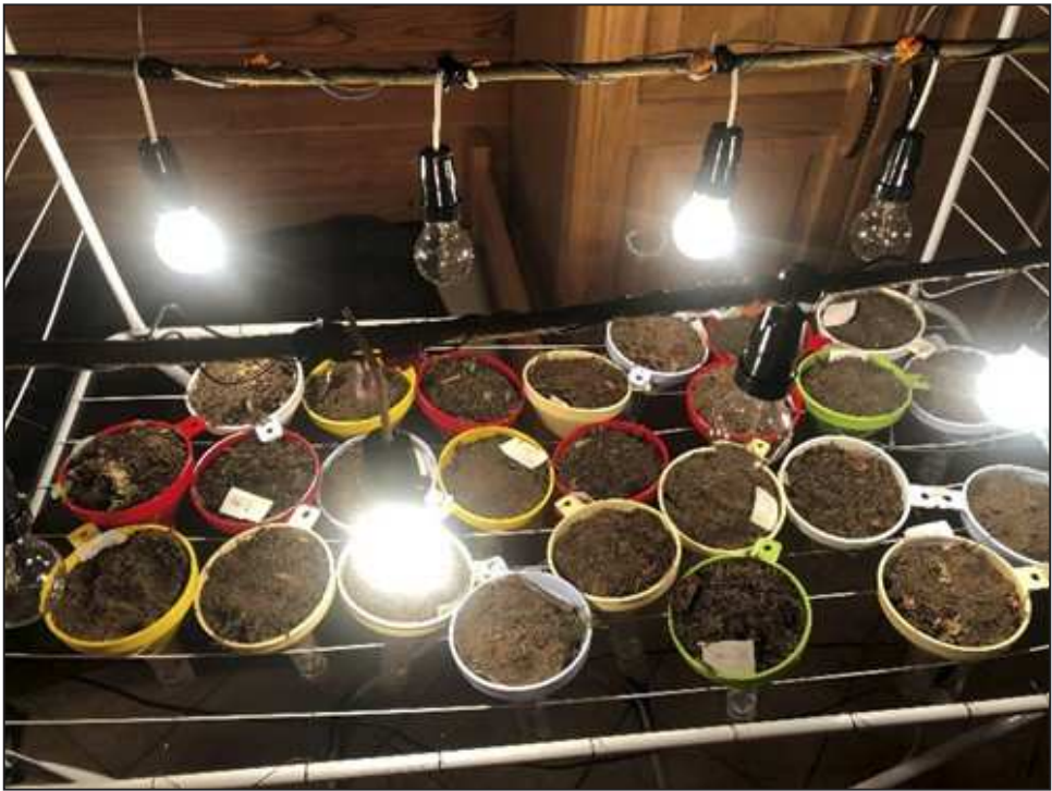
Fot. 2. Aparat Tullgrena służący do wypłaszania skoczogonków z prób glebowych Źródło: I. Kaprus'.
