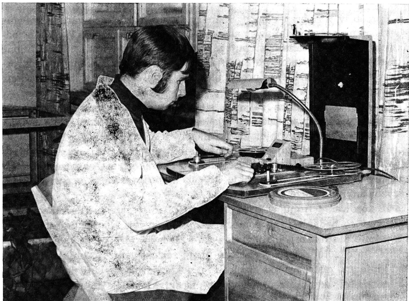
Rys. 5. Analiza jakościowa filmu badawczego przy pomocy stolika przeglądowego (fot. W. Woźniak)
