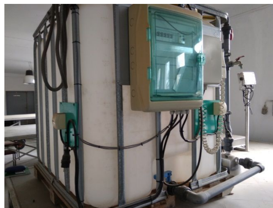
Fot. 4. Zbiornik do przygotowywania pożywki o pojemności 1000 litrów wraz z instalacją (fot. D. Boguszevska-Mańkowska)
