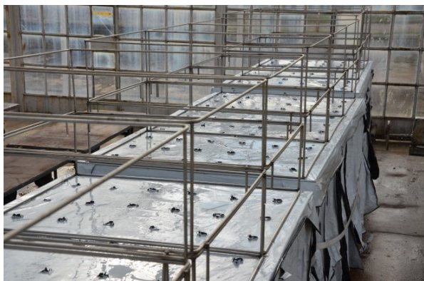
Fot. 1. Komora aeroponiczna. Widoczne są: stelaż do podtrzymywania części nadziemnej roślin, blat z otworami i foliowe zasłony boczne (fot. B. Wasilewska-Nascimento)
