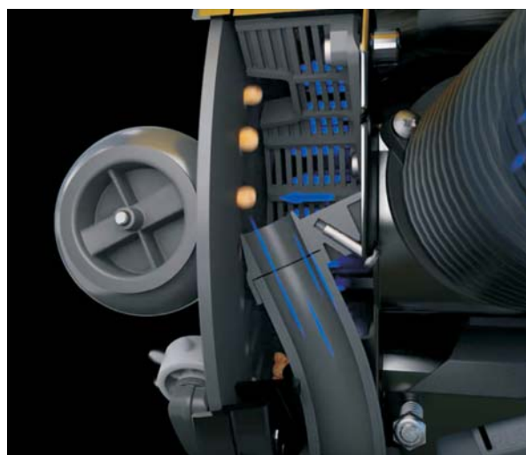
Rys. 4. Zespół dozowania nasion stosowany w siewnikach z serii Tempo [12] Fig. 4. Seed metering unit applied in Tempo series seeders [12]
