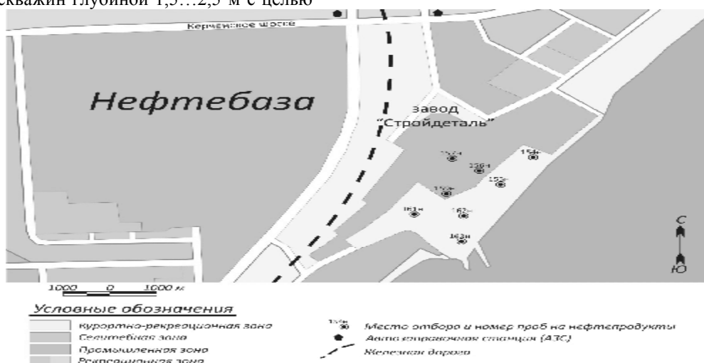
Рис. 2. Схема отбора экологических проб грунтовых вод из пробуренных скважин на территории завода «Стройдеталь»
