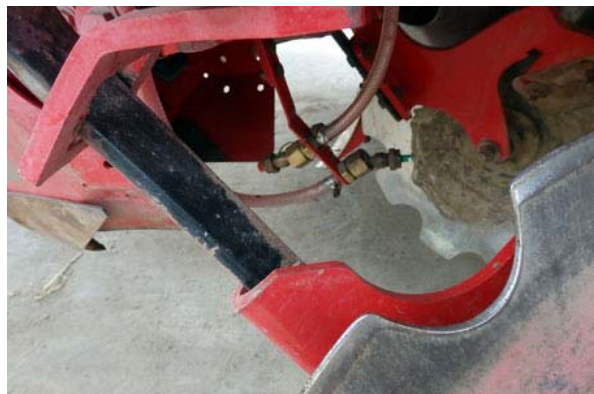
Fot. 10. Sposób zamontowania dysz przy oprysku drobnokroplistym
