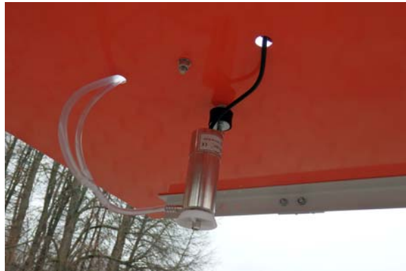
Fot. 11. Wirujący dysk w urządzeniu MANTIS ULV
