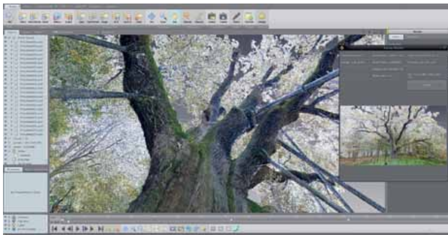
Ryc. 3. Proces renderowania filmu „Dąb Bartek – naziemne skanowanie laserowe” obrazującego chmurę punktów pochodzącą z naziemnego skanowania laserowego w październiku 2014 (RIEGL VZ-400; Laser3D)
