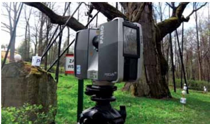
Ryc. 1. Lokalizacja skanera i sfer (skaner FARO FOCUS 3D) Fig. 1. Location of the scanner and spheres
