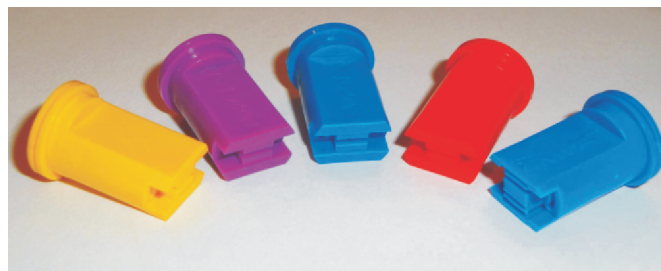
Rys. Widok rozpylaczy MMAT przyjętych do badań Fig. View of tested MMAT air-induction nozzles
