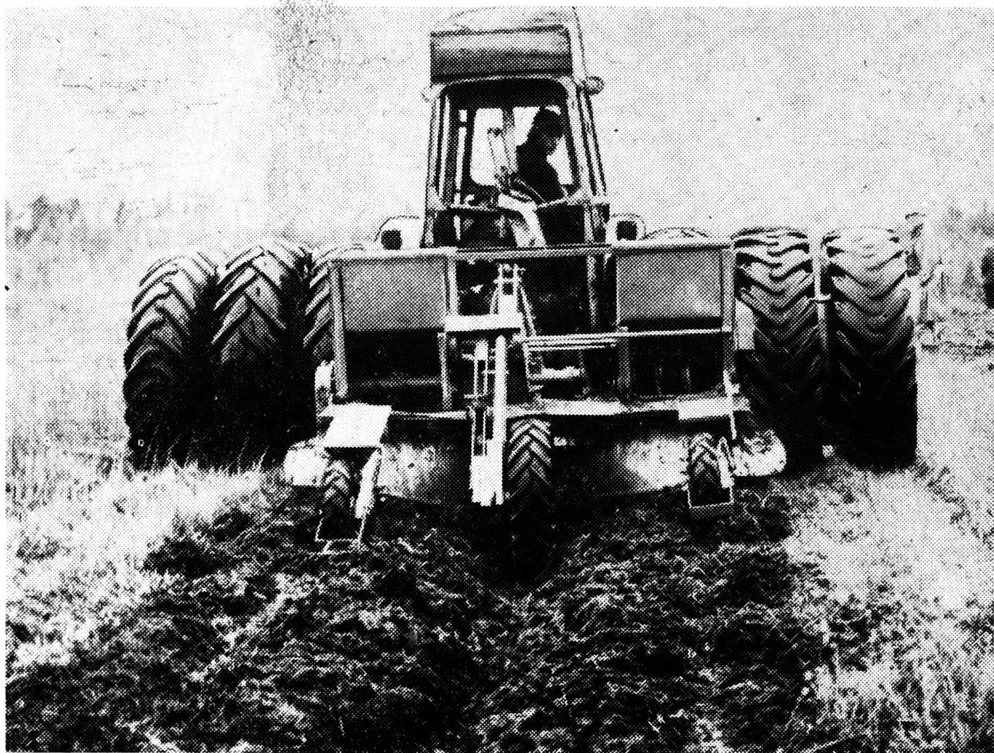
Fot. 5. Maszyna „Lamu V” do przygotowania gleby oraz do wysiewu nawozów i nasion na nieużytkach torfowych, zawieszana na ciągniku rolniczym
