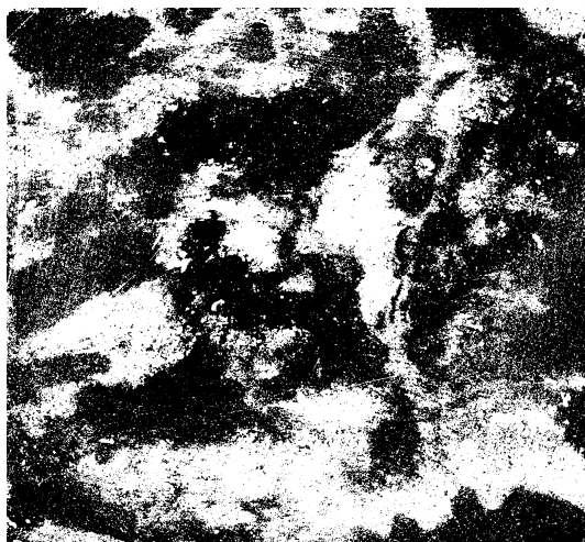
Rys. 5. Binarny obraz struktury wełny mineralnej. Barwa biała – faza stała, barwa czarna – pory; skala 0,75:1
