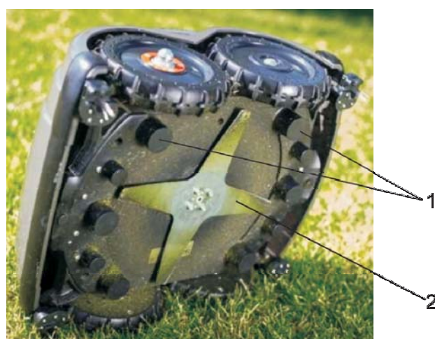
Rys. 2. Zespół tnący kosiarki automatycznej firmy Stiga: 1 - czujniki, 2 - nóż tarczowy [6] Fig. 2. Cutting assembly of the automatic mowing machine manufactured by Stiga: 1 - sensors, 2 - disc knife [6]
