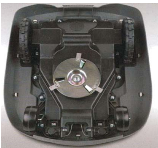
Rys. 4. Zespół tnący kosiarki automatycznej firmy Honda [6] Fig. 4. Cutting assembly of the automatic mowing machine manufactured by Honda [6]
