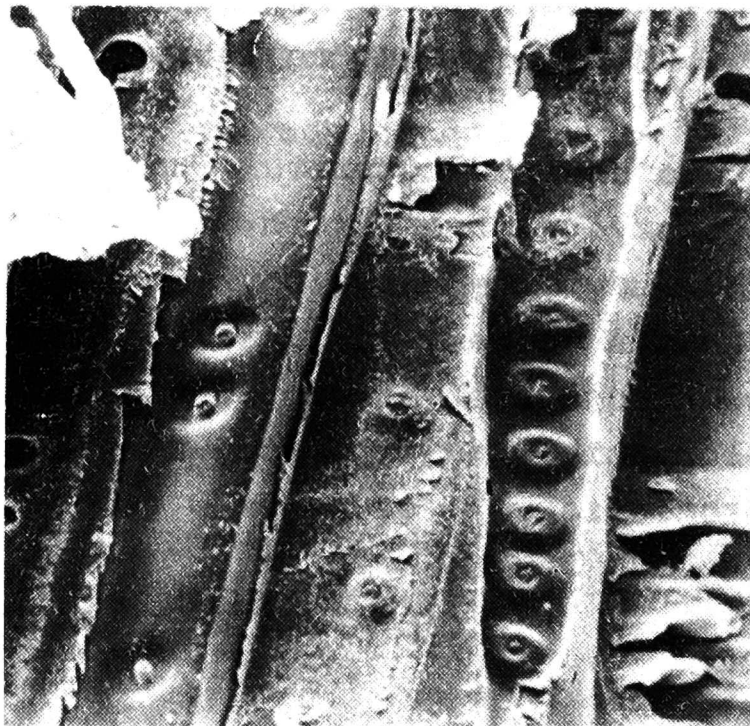
Rys. 7. Świerk impregnowany polimetakrylanem metylu, przekrój popodłużny, powiększenie 320 x
