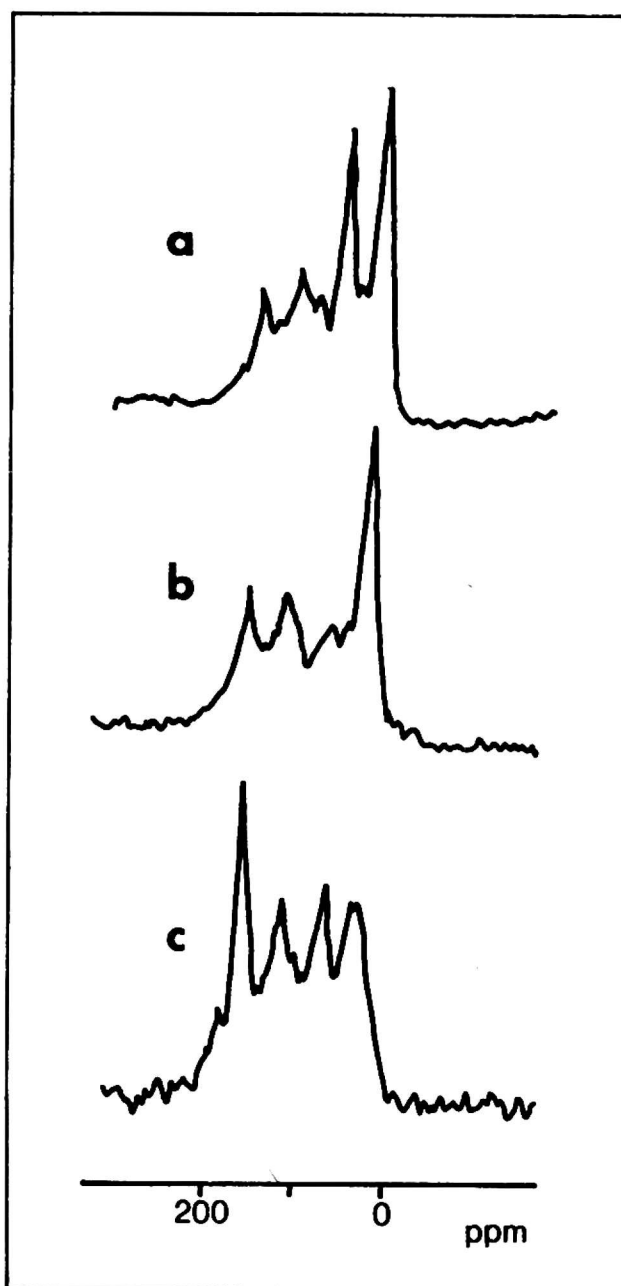
Rys. 9. Widma ^{13}\text{C} kwasów humusowych /a, b/ i kwasu fulwowego /c/ wykonane techniką CPMAS [26]
