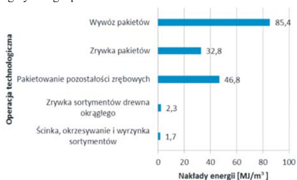
Rys. 5. Nakłady energii poniesione podczas wykonywania operacji technologicznych pozyskiwania pakietów pozostałości zrębowych Fig. 5. Energy inputs in technological operations in obtaining of bundles from logging residues
