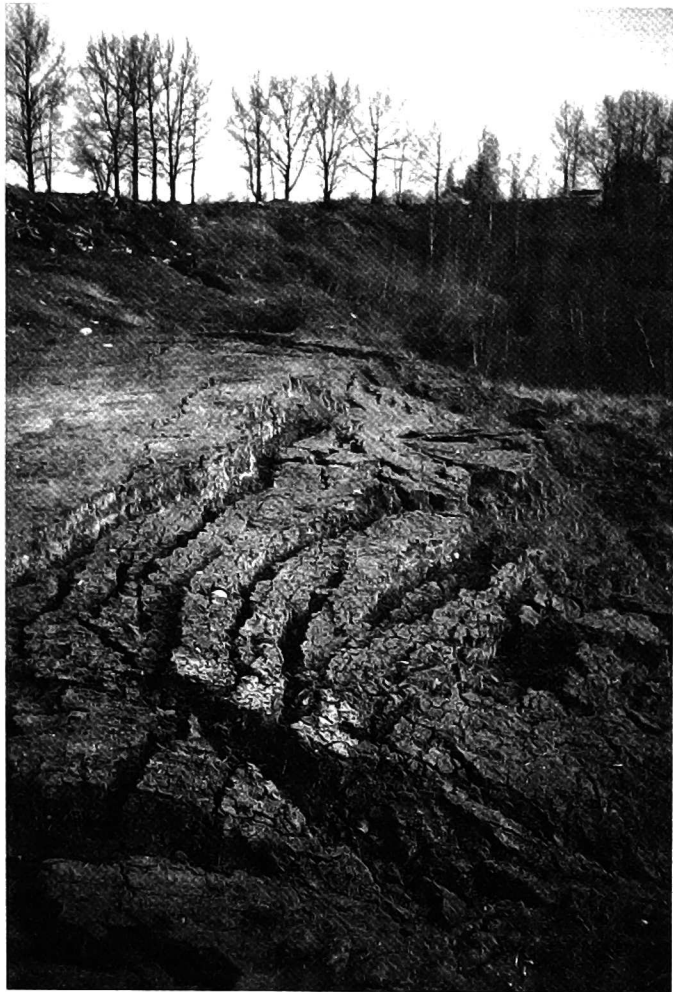
Fot. 1. Osuwisko na zachodniej skarpie wyrobiska C-2 Krotoszyn, stan z kwietnia 1999 r. (fot. MARKUSZEWSKA)
