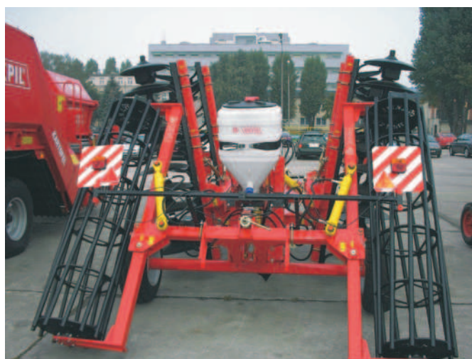
Rys. 2. Odejmowalna belka z tablicami ostrzegawczymi ze światłem zespolonym na maszynie przyczepianej Fig. 2. Disassembling beam and warning panels with combined lights on the trailed machine
