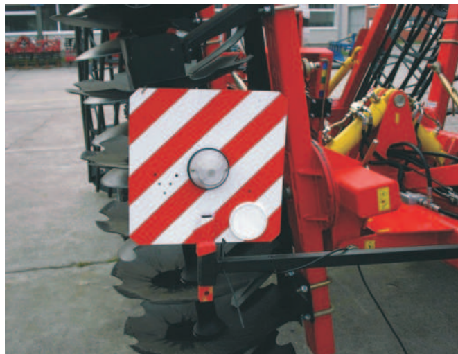
Rys. 1. Tablica ostrzegawcza ze światłem zespolonym zamocowana na stałe na maszynie zawieszanej
