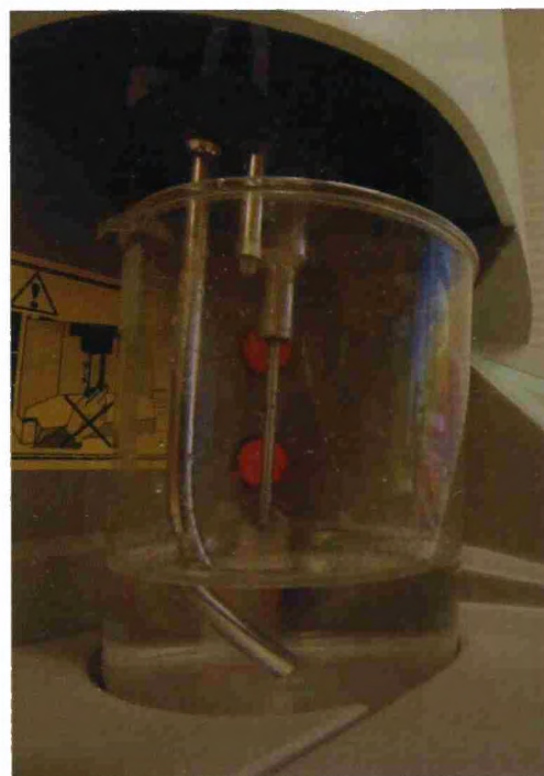
Rycina 1. Zawieszona włókien w trakcie pomiaru urządzeniem Kajaani FiberLab
