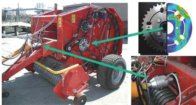
Rys. 7. Prasa zwijająca podczas badań laboratoryjnych obciążeń wałów roboczych Fig. 7. Round baler during laboratory tests of shafts loadings
