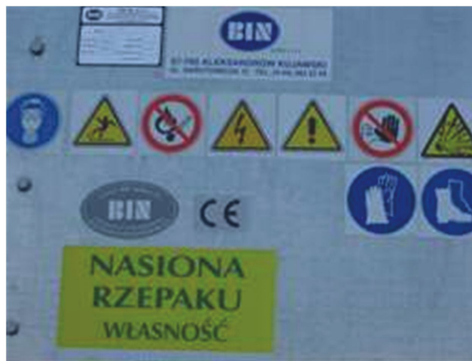
Rys. 8. Piktogramy informujące użytkownika o zasadach bezpiecznej obsługi silosu Fig. 8. Pictographs with safety instruction draws on the well of grain bin
