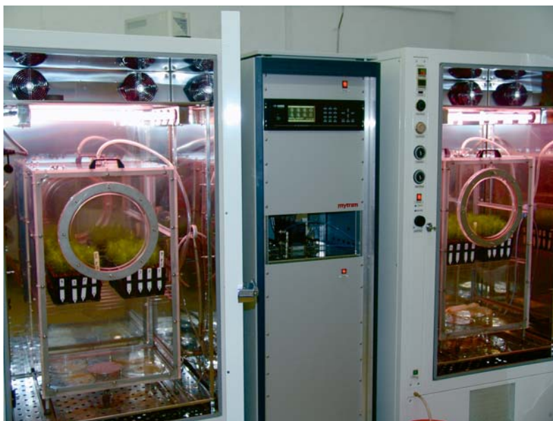
Fot. 1. Komory klimatyczne Mytron WB 750 oraz kontroler MKS Instruments 647 B do sterowania dopływem CO 2 , wykorzystane w hodowli porównawczej sadzonek sosny zwyczajnej (fot. P. Lech)
