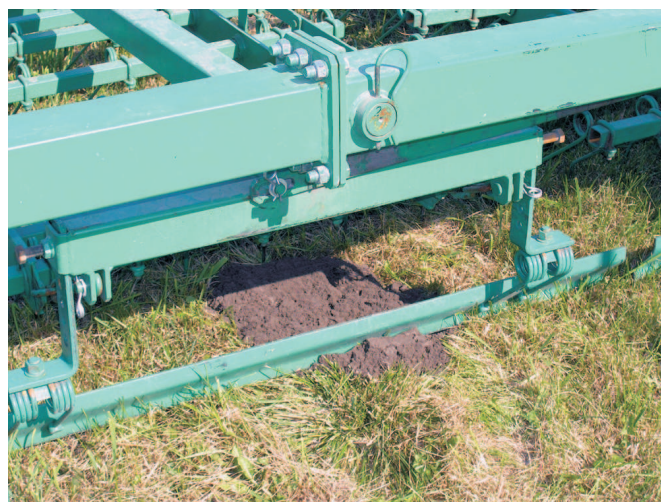
Rys. 3. Zagięte krawędzie nacierające przednich włók dobrze ścinają kretowiska
