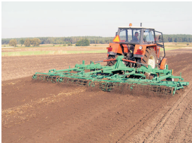
Rys. 4. Agregat 4-polowy podczas doprawiania gleby po orce
