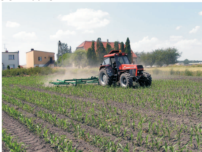
Rys. 2. Chwastownik 6-polowy podczas pielęgnacji kukurydzy
