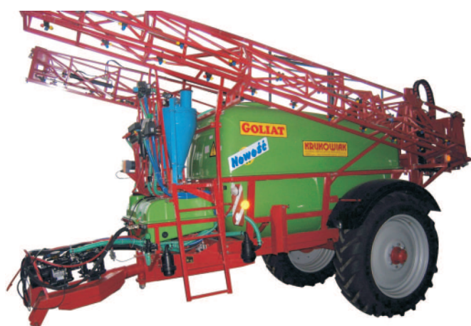
Rys. 5. Układ do wytwarzania cieczy roboczej zastosowano w opryskiwaczach do ochrony roślin produkcji Kujawskiej Fabryki Maszyn Rolniczych „KRUKOWIAK”
