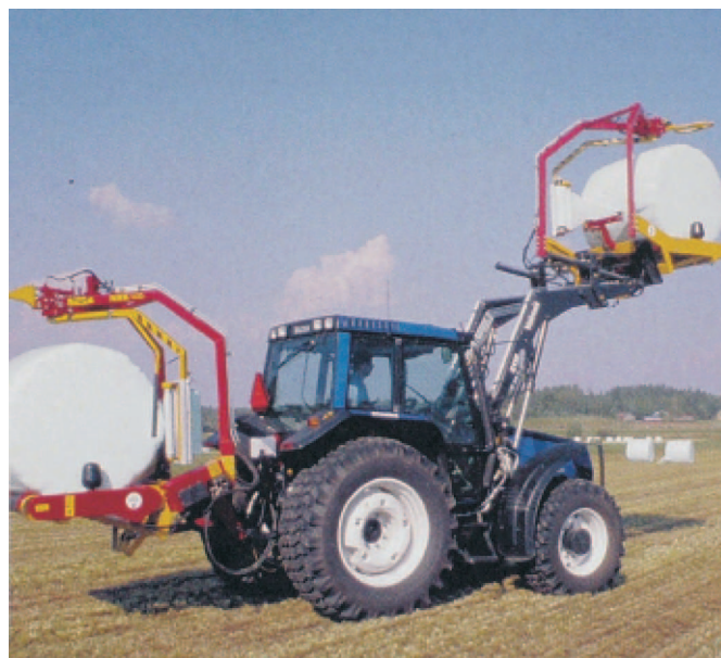
Rys. 8. Dwie owijarki zamontowane na ładowaczu czołowym i tylnym TUZ
