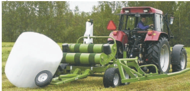
Rys. 2. Owijarki z załadunkiem: a - tylnym, b - bocznym Fig. 2. The round bale wrappers with rear loading (a) and side loading
