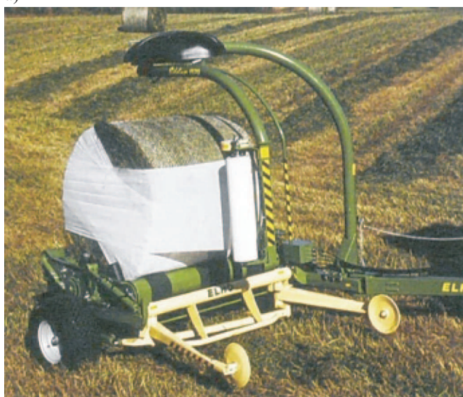
Rys. 4. Owijarka nabudowana na podwoziu prasy firmy New Holland compact
