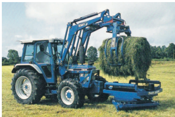
Rys. 1. Załadunek bel na owijarkę z zastosowaniem ładowacza czołowego z chwytakiem
