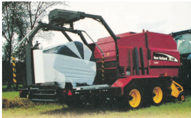
Rys. 4. Owijarka nabudowana na podwoziu prasy firmy New Holland compact
