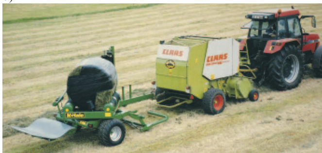
Rys. 3. Owijarki z załadunkiem: a - czołowym, b - czołowym we współpracy z prasą
