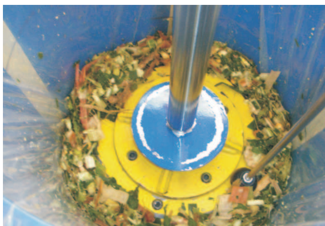
Rys. 3. Cylinder zagęszczający w czasie prasowania materiału roślinnego za pomocą tarczy dociskowej
