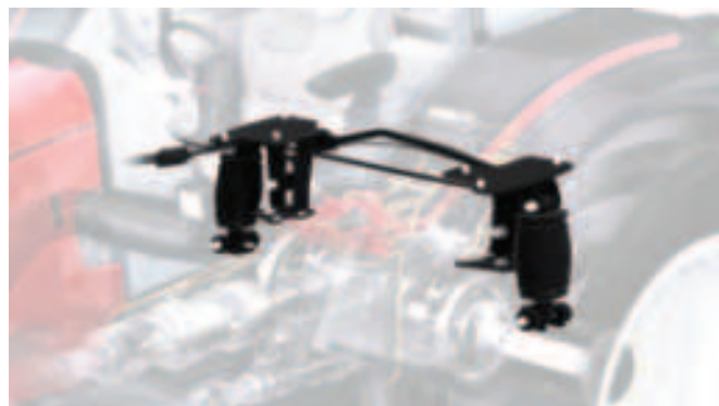
Rys. 12. Półaktywne zawieszenie kabiny AutoComfort prod. Valtra Inc. (Finlandia) Fig. 12. AutoComfort semi active cabin mounting manufactured by Valtra Inc. (Finland)
