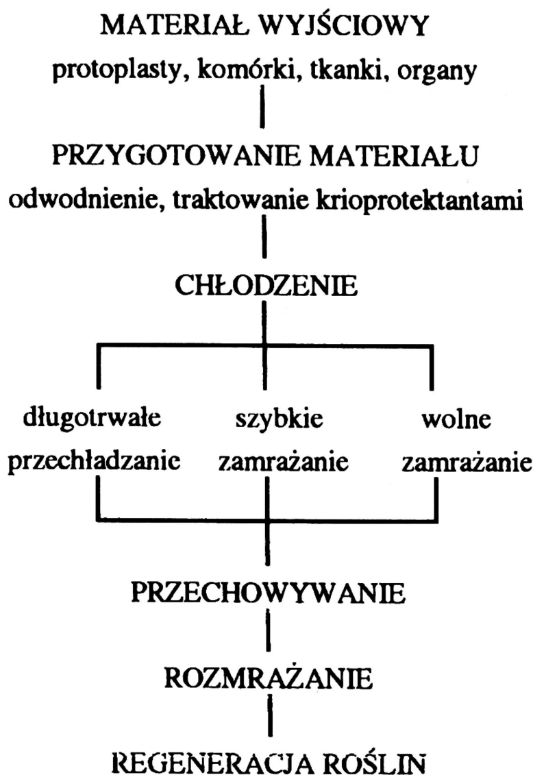
RYC. Schemat zamrażania i przechowywania materiału roślinnego w ciekłym azocie (3- modyfikacja)
