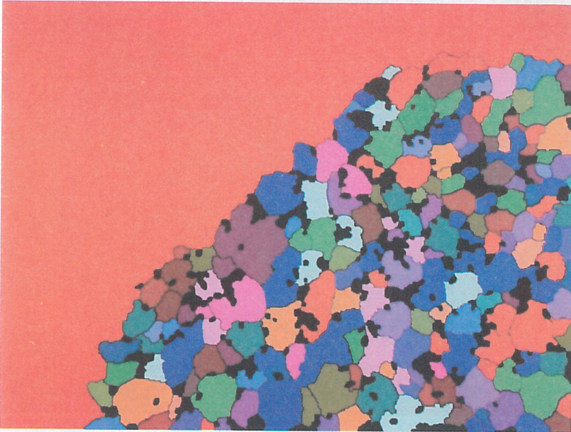
Rys. 8. Obraz po usunięciu małych obiektów nie będących komórkami (procedura AphImgAreaOpen ). Fig. 8. Image after deleting of small (not cells) objects (procedure AphImgAreaOpen ).
