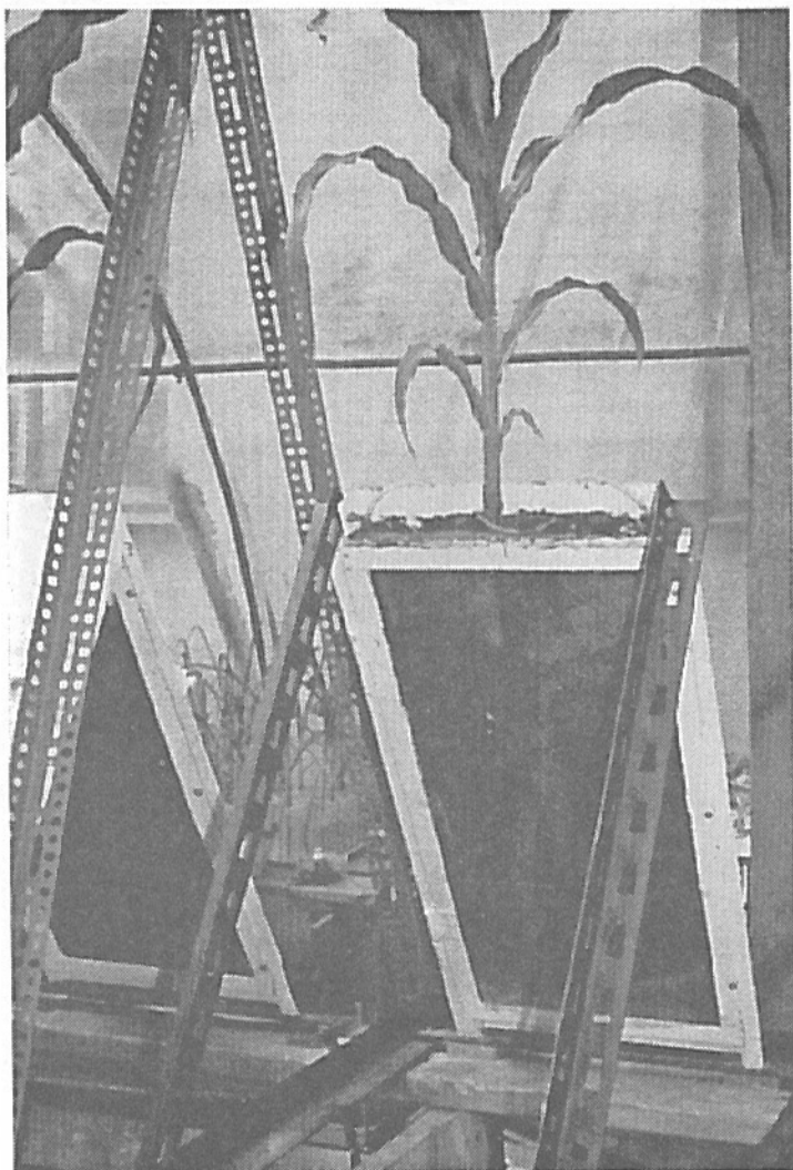
Fot. 4. Widok wewnętrznej szklanej ściany rizotronu
