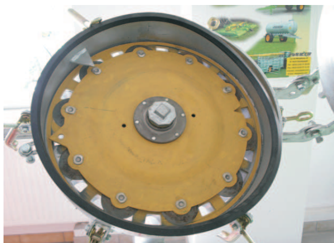
Rys. 1. Rozdzielacz firmy Joskin wyposażony w system tnący SCALPER® Fig. 1. Devider of company Jaskin equipped with cutting system SCALPER®
