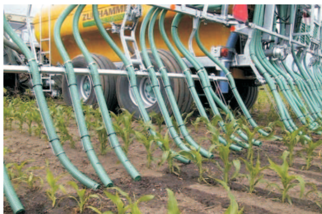
Rys. 6. Sprężynowe prowadnice utrzymują węże w międzyrzędziach kukurydzy
