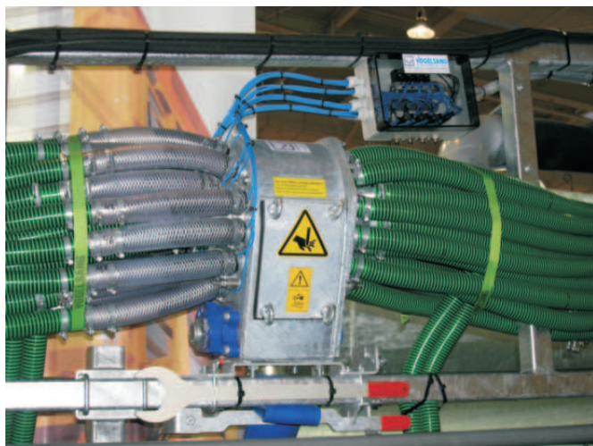
Rys. 3. W rozdzielaczu ExaCut gnojowica dostaje się boczną rurką wlotową bezpośrednio do korpusu rozdzielacza (Agritechnica 2007)
