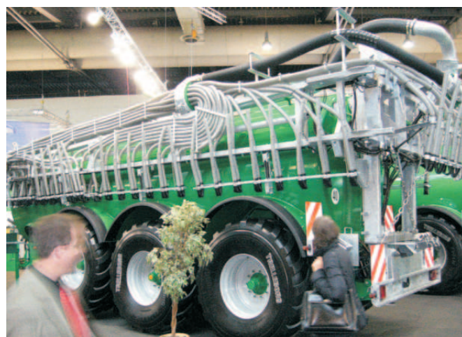
Rys. 7. W położeniu transportowym węże skierowane są ku górze, co zabezpiecza przed niekontrolowanym wyciekiem (wóz firmy Samson, Agritechnica 2007)
