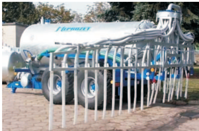
Rys. 5. System węży wleczonych firmy Meprozet Kościan
