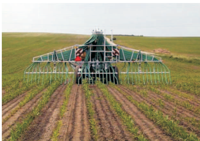
Rys. 4. System węży wleczonych pozwala aplikować gnojowicę jak najbliżej rośliny (system firmy Zunhammer)
