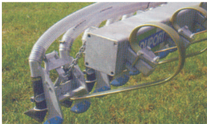
Rys. 8. Firma Duport montuje zespoły robocze na elementach sprężystych
