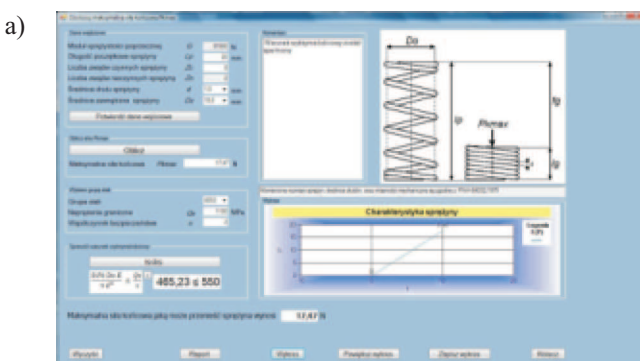
Rys. 4. Formularze obliczeniowe dla sprężyn istniejących Fig. 4. Calculation forms for existing springs
