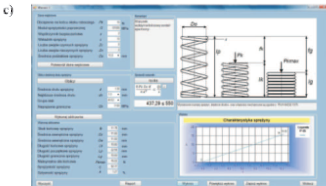
Rys. 3. Formularze obliczeniowe dla nowo projektowanych sprężyn; przypadki a, b, c, d odpowiadają wariantom 1, 2, 3, 4 formularza z rys. 2 b Fig. 3. Calculation forms for springs newly designed; a, b, c, d cases correspond to 1, 2, 3, 4 variants of form from fig. 2 b
