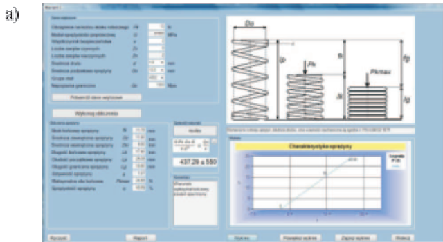
Rys. 2. Okno startowe programu Sprężyna (a), formularz wyboru wariantu procedury obliczeniowej (b) Fig. 2. Start window of Sprężyna program (a), form of variant choice for calculation procedure (b)
