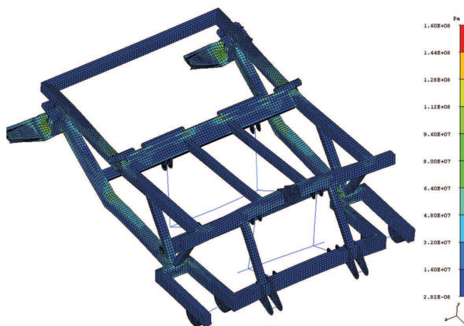
Rys. 16. Naprężenia zredukowane [Pa], sadzarka trzyrzędowa, przypadek LC1
