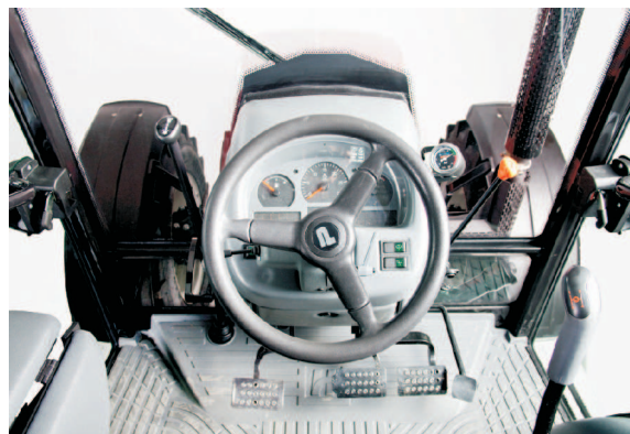
Rys. 2. Widok wnętrza kabiny w ciągniku POLMOT8014 H [2] Fig. 2. View on cabin inside in the tractor POLMOT8014 H [2]
