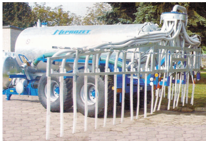
Rys. 7. Wóz asenizacyjny wyposażony w urządzenie do naglebowego dozowania gnojowicy, prod. „Meprozet Kościan”, S.A. Kościan
