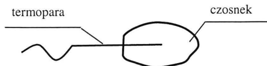
Rys. 3. Metoda pomiaru temperatury w centrum termicznym ząbka czosnku.
