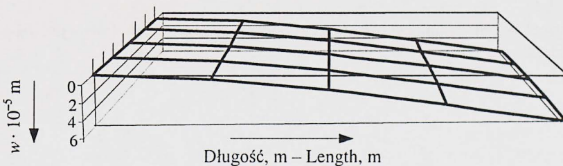
Rys. 6. Odkształcona postać powierzchni środkowej płyty w chwili t = 0,3 s Fig. 6. Deformed form of central area of a plate at time t = 0,3 s
