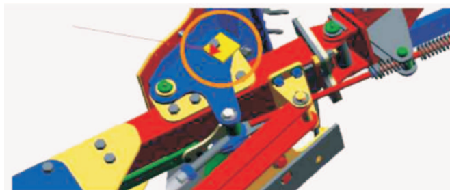
Rys. 2. Miejsce ustawienia korpusów płuznych przy skokowej regulacji szerokości roboczej (30, 36, 39, 44 cm) w pługu zagonowym U-183/1, prod. PP-U-H „AKPIL” Pilzno
