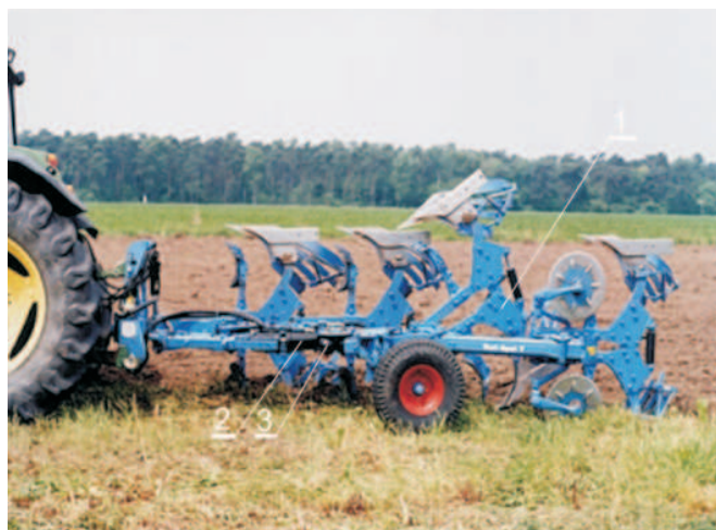
Rys. 8. Widok pług obracalnego „Vari Opal 9” z hydraulicznym zabezpieczeniem przeciążeniowym w czasie pracy, prod. Lemken GmbH&Co. KG: 1 - korpus pługowy, 2- siłownik, 3- akumulator hydrauliczno-gazowy
