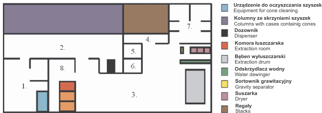
Rycina 1. Schemat wyłuszczeni w Jarocinie: 1 – hala przyjęć i wstępnego oczyszczania, szyszek, 2 – magazyn szyszek, 3 – hala produkcyjna, 4 – magazyn nasion, 5 – kielkownia, 6 – mała chłodnia, 7 – pomieszczenia socjalne, 8 – maszynownia
