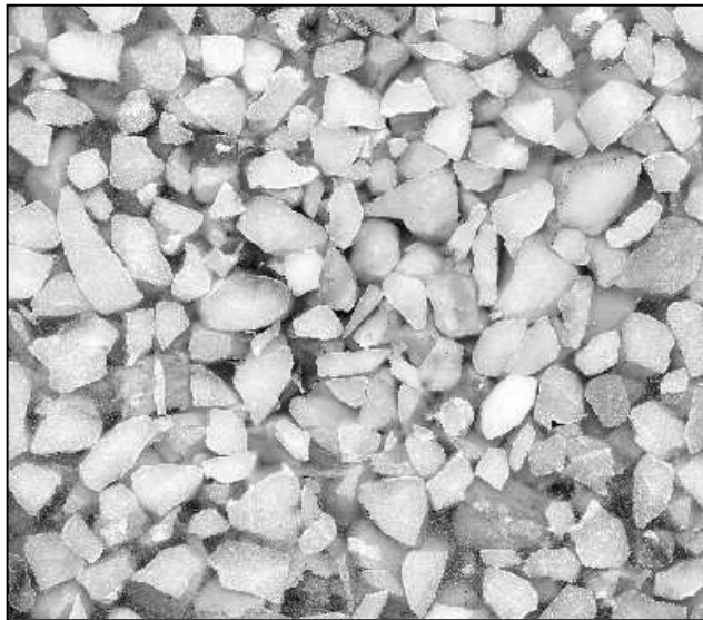
Rys. 11. Rzeczywisty obraz struktury gysu; skala 0,85:1 Fig. 11. Real image of structure of grit; scale 0.85:1
