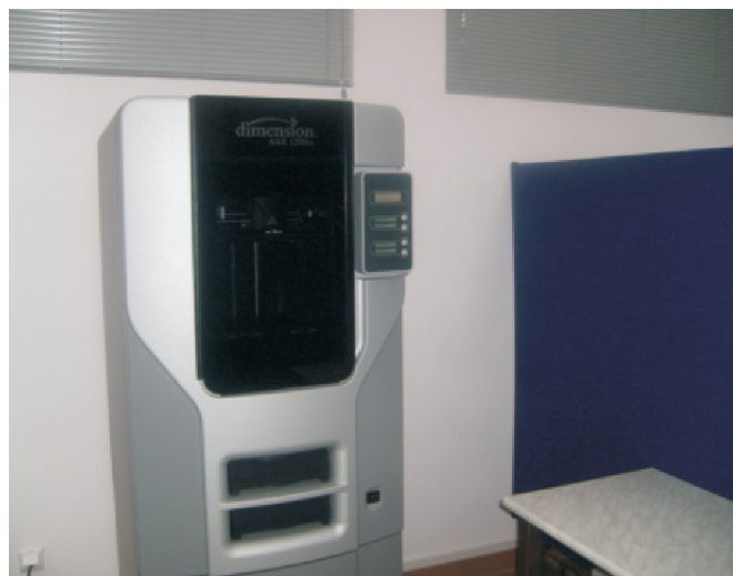
Rys. 4. Drukarka przestrzenna DIMENSION 1200es (technologia FDM), prod. STRATASYS Co.(USA), znajdująca się w Laboratorium Rapid Prototyping w Przemysłowym Instytucie Maszyn Rolniczych w Poznaniu Fig. 4. DIMENSION 1200es (FDM technology) 3D Printer, produced by STRATASYS Co.(USA), placed in Industrial Institute of Agricultural Engineering in Poznan
